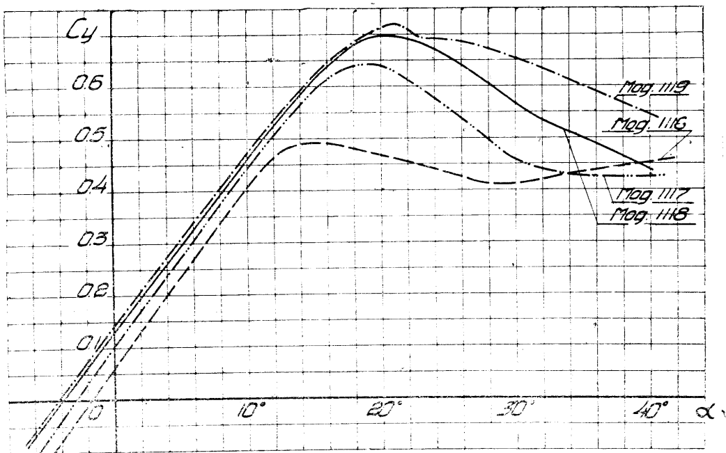
Фиг. 16. Сводная диаграмма кривых C_y моделей крыльев различных профилей.
